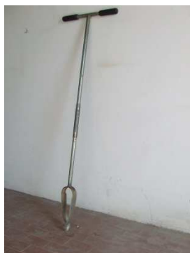
Figura 42 - Trivella elicoidale per prelievo campioni terreno
