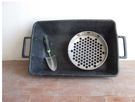
Figura 43 - Setaccio utilizzato per la vagliatura di campioni di terreno
