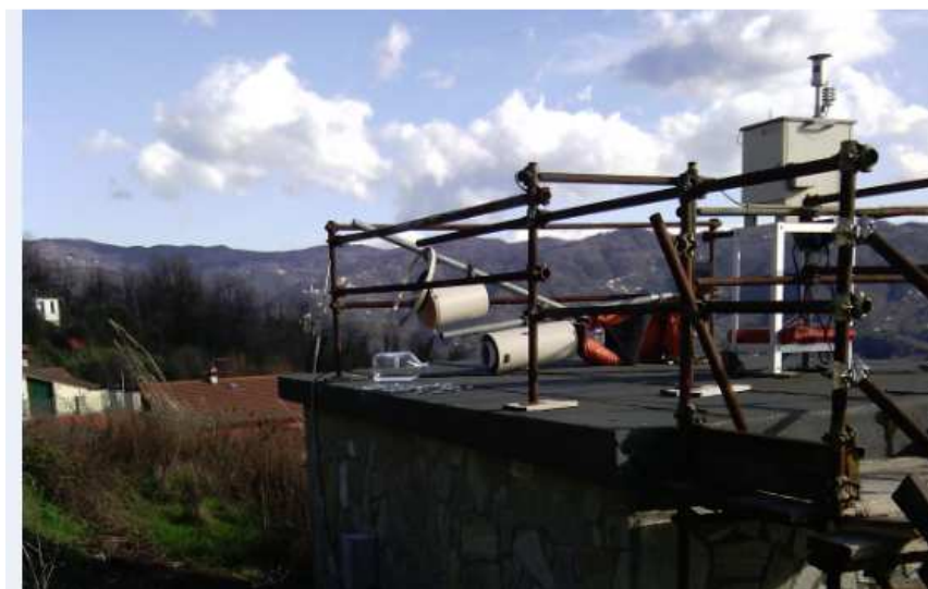
Figura 3 – Rovesciamento e rottura dei deposimetri presso la postazione di Follo nella corso della P14 15/2.
