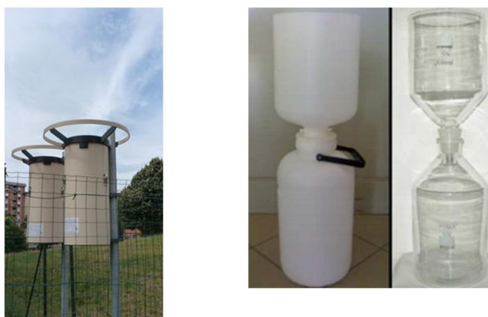
Figura 3 – Deposimetri in configurazione di prelievo.
