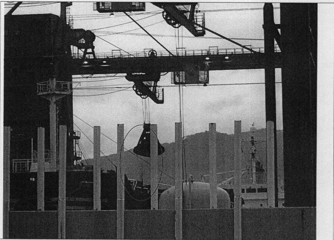
Fig. 2 Ricaduta di materiale dalla benna
