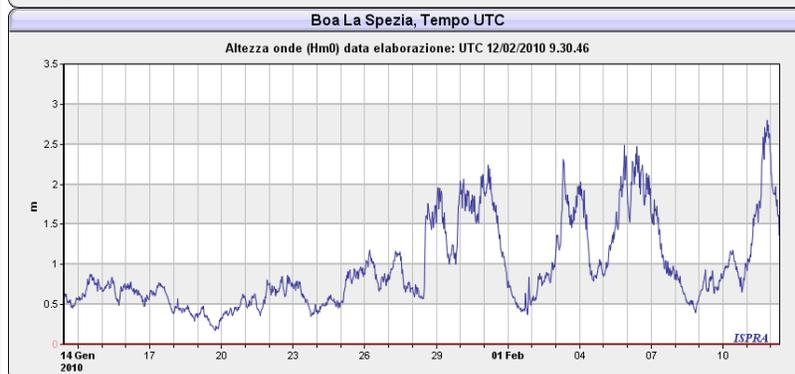
Figura 6 Altezze d'onda significativa e massima registrate dalle boe di Costa Azzurra (MeteoFrance) e La Spezia (ISPRA).
