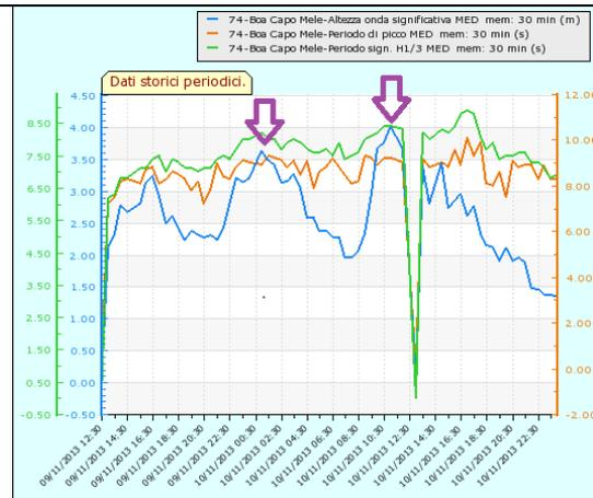
Figura 47 Andamento dell'altezza d'onda significativa (metri, linea azzurra), del periodo di picco (linea arancio) e del periodo medio di onda (secondi, linea verde) registrati dalla boa di Capo Mele. Si osserva la presenza dei due picchi di altezza d'onda, analogamente a quanto registrato a levante.
