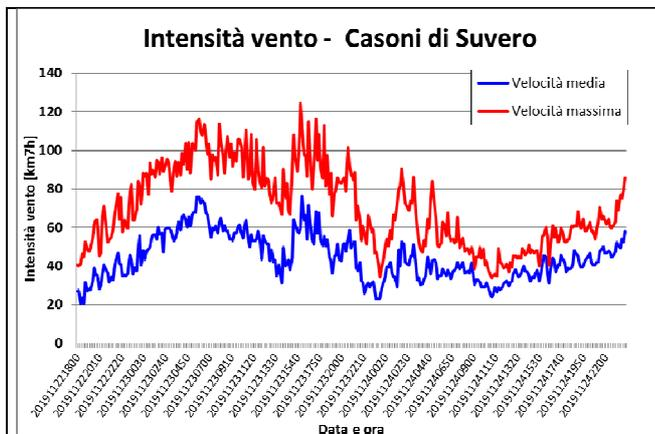
Figura 49 Grafico dell'intensità di vento registrata dalla stazione anemometrica di Casoni di Suvero [1070 m.s.l.m.] nella finestra temporale dell'evento in oggetto.
