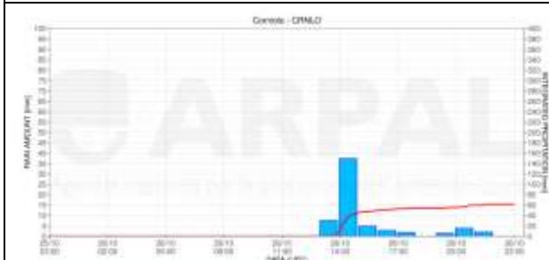
Figura 19 Ietogramma e cumulata relativi alla stazione di Corniolo (C) INTENSITA': FORTI (mm/1h), Moderate (mm/3h) QUANTITA': ELEVATE (mm/6h, mm/12h), Significative (mm/24h)
