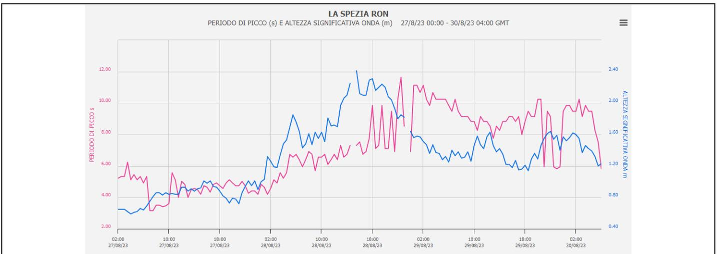
Figura 33 Altezza onda significativa (linea azzurra) registrata dalla boa di La Spezia (Rete Ondametrica Nazionale) e relativo periodo di picco (linea fucsia)
