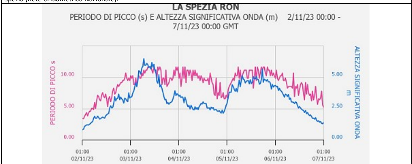
Figura 38 Andamento dell'altezza d'onda significativa (m, linea azzurra) e del periodo di picco (s, linea arancio) registrati dalla boa di La Spezia (Rete Ondametrica Nazionale).
