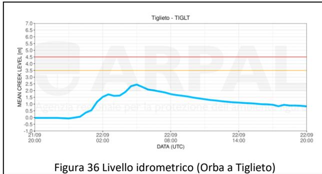
Figura 36 Livello idrometrico (Orba a Tiglieto)
