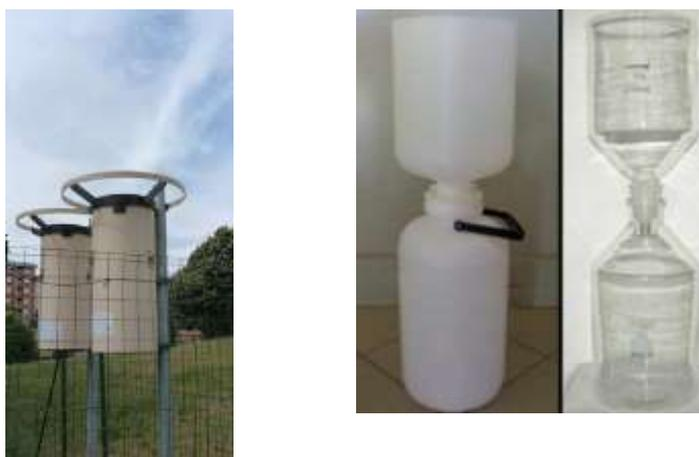
Figura 2 – Deposimetri in configurazione di prelievo.
