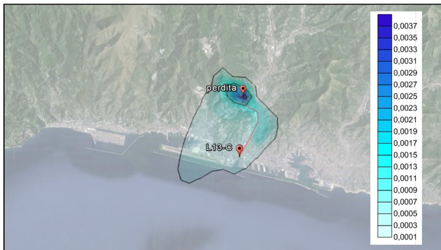
Figura 9: sviluppo delle curve di iso-concentrazione (ppm) nelle prime 15 ore dopo il rilascio, lungo i corsi d'acqua interessati (si riporta la valutazione alla quota di 2m, più rappresentativa dell'impatto sulla popolazione)
