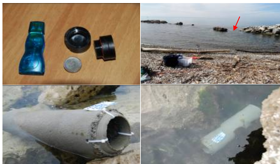
Figura 5.12 – Termometro iButton (Ditta Maxim Dallas Semiconductor). Nella foto in alto a destra la freccia indica il punto di posizionamento del termometro nella pozza di marea a Canovella de'Zoppoli. Nelle foto in basso il tubo di cemento utilizzato per l'ancoraggio del termometro e il suo posizionamento tra gli scogli.
