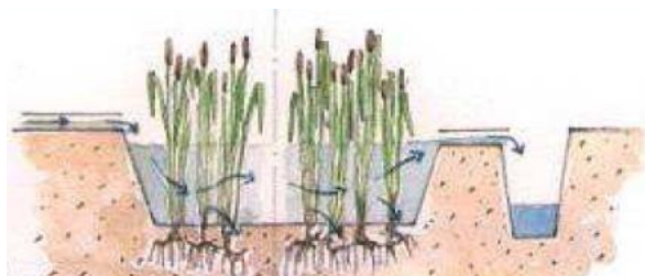
Figura 5: Rappresentazione schematica di un sistema a flusso superficiale
